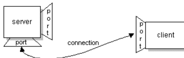
Figura 7. Servidor acepta la solicitud y establece la conexión con el cliente.
